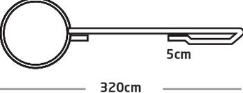
Am anderen Ende legt man eine Schlaufe, so daß die Gesamtlänge 320cm beträgt und klebt das Ende am Polyamidschlauch fest.
