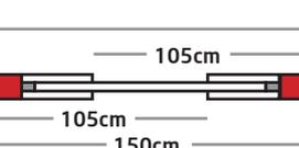
Die Schaumstoffklötze werden mit Klebeband (je 4 Streifen à 30cm) an dem Polsterrohr befestigt und dabei so gestaucht, dass 105 cm zum Beginn der anderen Schlagfläche liegen.
