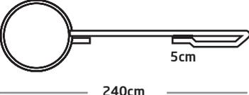
Am anderen Ende legt man eine Schlaufe, so daß die Gesamtlänge 240cm beträgt und klebt das Ende am Polyamidschlauch fest.
